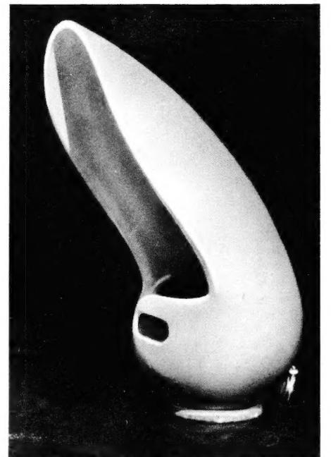
Bild 1. Der »Elipson«-Lautsprecher in neuer Ausführung
